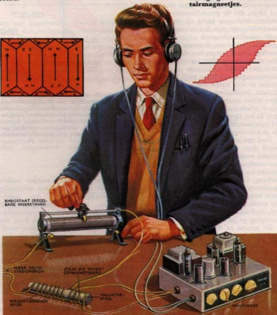
Het 'inluisteren' van de bewegingen van de elementairmagneetjes in een stukje ijzer. De kleine spoel die om de ijzeren staaf is gewonden, werkt als een soort antenne, die de elektromagnetische golven opvangt, die worden uitgezonden als een elementairmagneetje zich omkeert. Als de stroom, die de spoel magnetiseert van richting verandert, wordt een opeenvolging van klikken gehoord.
